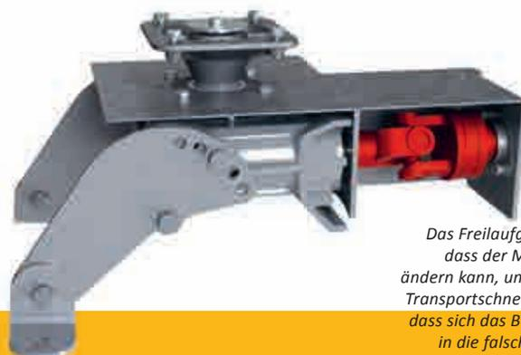
*Das Freilaufgelenk sorgt dafür, dass der Motor die Richtung ändern kann, um Blockaden in der Transportschnecke zu lösen, ohne dass sich das Bodenrührwerk mit in die falsche Richtung dreht.*
