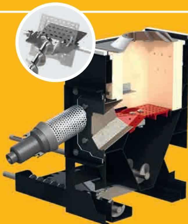
**Optimierte Zündung spart Energie.** Bei kurzen Feuerpausen bleibt die Schamottbrennkammer heiß genug, damit sich frisch eingeschobenes Brennmaterial einfach an der Restglut entzündet. Nur nach längerem Kesselstillstand kommt das Zündgebläse zum Einsatz. Sobald Lambdasonde und Abgastemperaturfühler signalisieren, dass die Anfeuerung erfolgreich war, schaltet sich die Zündung sofort ab. Das spart Energie!
