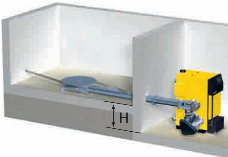
**ETA-Tipp:** Für eine waagrechte Austragung sind folgende Höhenunterschiede zwischen Lagerraum und Heizraum nötig:
